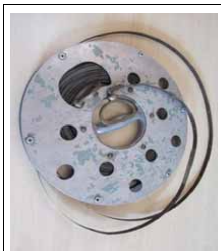
Messkette (Stahlband mit Dezimetererteilung)
